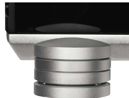
Nóżki są solidne i funkcjonalne; zamiast kołców niszczących parkiet, przygotowano „zawieszenie” na kulkach pomiędzy krążkami.
